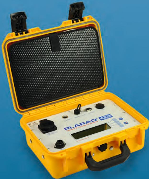
Das mikroprozessorgesteuerte Gerät GMV 2 in baustellengerechter Ausführung ist unsere zentrale Prüfeinheit. Zusammen mit Messwertaufnehmern oder Prüfadaptern ermöglicht es präzise Messungen der Drehmomente während des Schraubens. Die Messwerte werden mit Datum und Uhrzeit gespeichert und können vom Gerät direkt ausgedruckt oder zur weiteren Auswertung in den PC übertragen werden.
